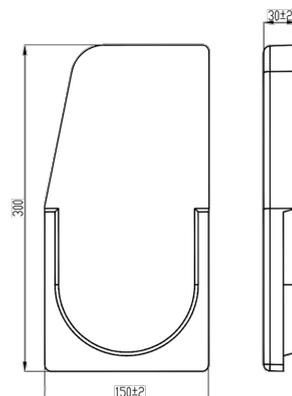
Заглушка полимербетонная для бордюра водоотводного ComroMax DN100, предназначена для установки в начале линии бордюров.
