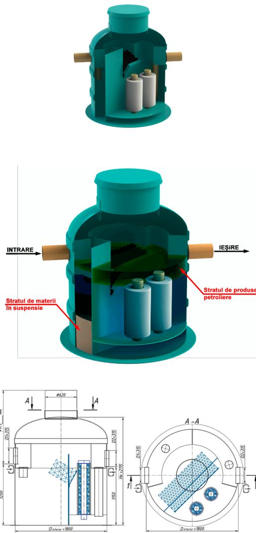
**Сепараторы нефтепродуктов VODALAND, новая название OilAbsorb700** с расходом **Q=8,0 л/сек** представляют собой цельные установки из полиэстера армированного стекловолокном (PAFS), предназначенные для улавливания, отделения и удержания нефтепродуктов (масел, дизельного топлива и других веществ нефтяного происхождения) и твердых частиц из дождевых вод с концентрацией до **700 мг/л** (из дождевых, талых и промышленных сточных вод), чтобы не загрязнять почву и водные ресурсы.
