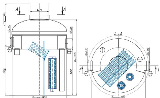
**Комбинированная система очистки OilAbsorb** представляет собой сочетание сорбционного фильтра и сепаратора нефтепродуктов в одном корпусе и устанавливается в случаях, когда невозможно установить два вида оборудования по отдельности (также может называться "**Сепаратор нефтепродуктов с фильтрами доочистки**").
