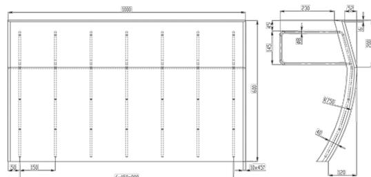
Радиальные мостовые карнизы из полимербетона - это элемент оборудования мостовой конструкции, составляющий внешнюю оболочку несущей конструкции моста.
