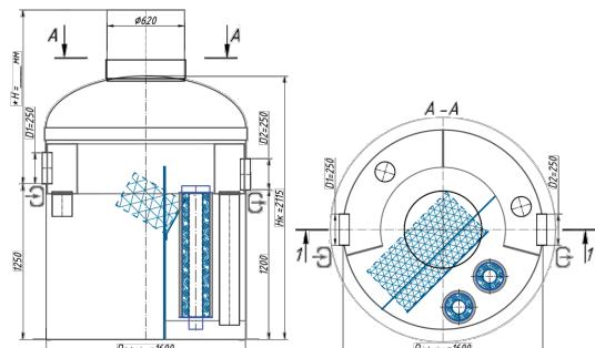
**Комбинированная система очистки OilAbsorb** представляет собой сочетание сорбционного фильтра и сепаратора нефтепродуктов в одном корпусе и устанавливается в случаях, когда невозможно установить два вида оборудования по отдельности (также может называться "**Сепаратор нефтепродуктов с фильтрами доочистки**").
