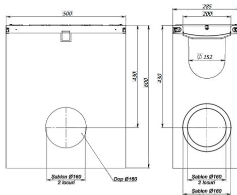
Пескоуловитель VetoMax DN150 с внутренним сечением 150 мм, укомплектован решеткой щелевой чугунной класса E600 (выдерживающей нагрузку до 60 тонн), устанавливается в местах с высокой интенсивностью движения (АЗС, автомойки, промышленные зоны, транспортные терминалы, автодороги и автопредприятия) в совокупности с линией водоотводных лотков, непосредственно в точке сброса/подключения к трубопроводу через имеющиеся шаблоны под врезку в трубу.
