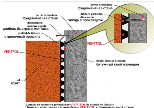
Мембрана HDPE VENTFOL Fundamentowa, плотность 350гр/м2 (рулон 3X20м) - это шиповидная профильная мембрана с отформованными округлыми выступами высотой 8мм.
