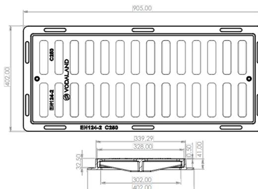
Решетка чугунная ливневая с рамой, класса нагрузки C250. Надежное закрытие решетки с рамой осуществляется запорным механизмом.
