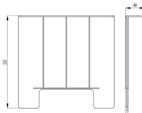
Перегородка-сифон PP BASE для дождеприемника Base 300x300
