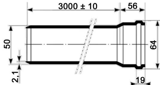
Труба ПП многослойная диаметр 50 мм, длина 3,0 метра, толщина стенки 2,0 мм, предназначена для внутренней канализации, хозяйственно-бытовой или ливневой канализации.
