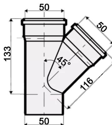
Тройник, ПП, D50x50мм, на 45 градусов, шумопоглощающий, для труб D50 использованных в внутренней канализации
