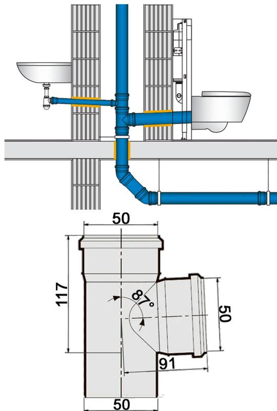
Тройник, ПП, D50x50мм, на 87 градусов, шумопоглощающий, для труб D50 использованных в внутренней канализации
