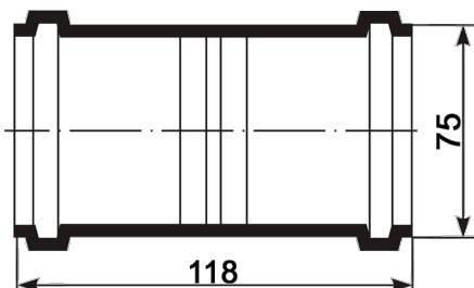
Муфта с ограничителем, ПП, D75мм, шумопоглощающая, для труб D75 использованных в внутренней канализации
