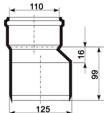
Переход, ПП, D125-D110мм, Ultra dB, шумопоглощающий, для труб D125 и D110 использованных в внутренней канализации
