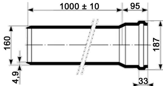
Труба ПП многослойная диаметр 160 мм, длина 1,0 метра, толщина стенки 4,9 мм, предназначена для внутренней канализации, хозяйственно-бытовой или ливневой канализации.
