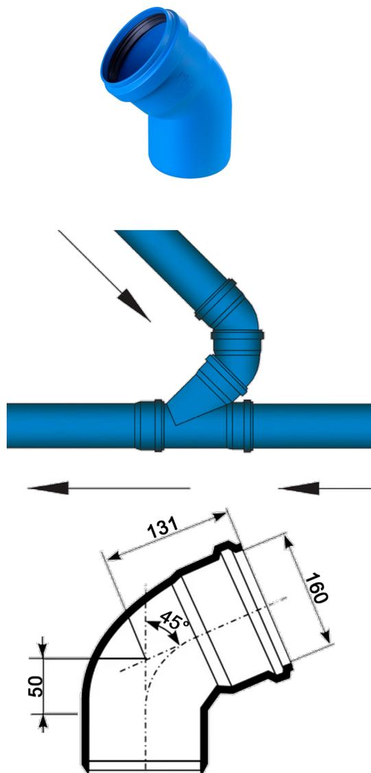
Отвод, ПП, D160мм, на 45 градусов, шумопоглощающий, для труб D160 использованных в внутренней канализации
