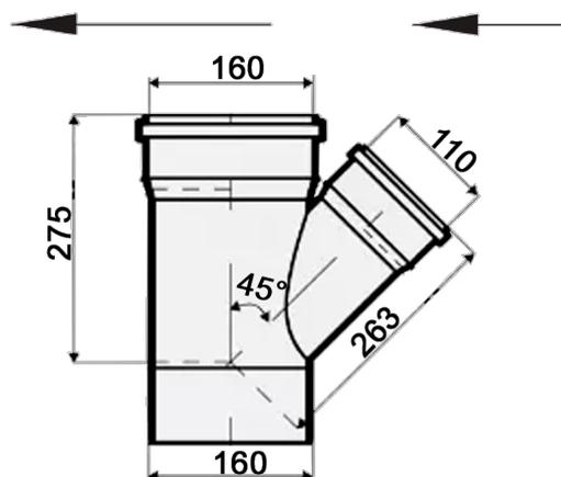
Тройник, ПП, D160x110мм, на 45 градусов, шумопоглощающий, для труб D160 и D110 использованных в внутренней канализации
