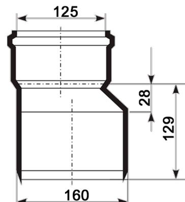
Переход, ПП, D160-D125мм, Ultra dB, шумопоглощающий, для труб D160 и D125 использованных в внутренней канализации
