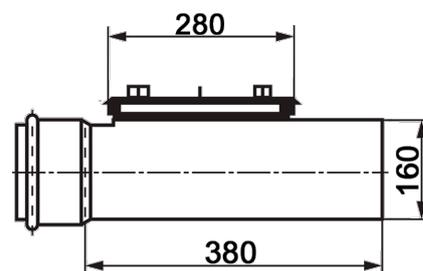
Ревизия, ПП, D160мм, Ultra dB, шумопоглощающая, для труб D160 использованных в внутренней канализации
