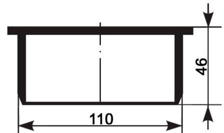
Заглушка ПП, D110мм, шумопоглощающая, для труб D110 использованных в внутренней канализации
