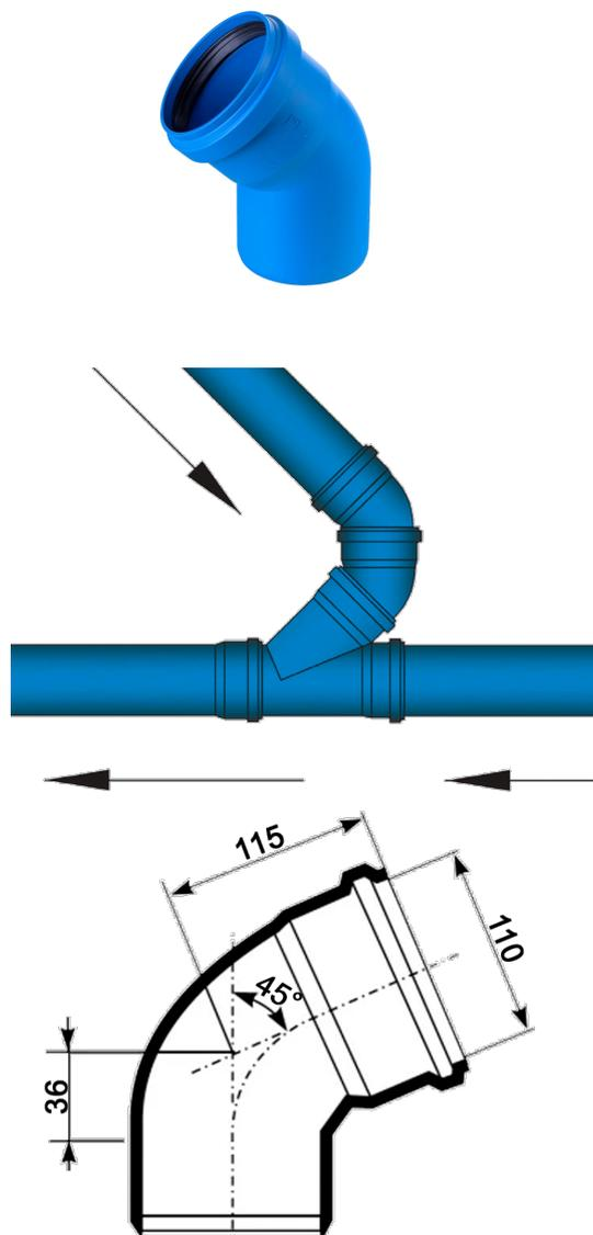
Отвод, ПП, D110мм, на 45 градусов, шумопоглощающий, для труб D110 использованных в внутренней канализации
