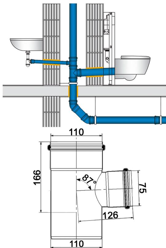
Тройник, ПП, D110x75мм, на 87 градусов, шумопоглощающий, для труб D110 и D75 использованных в внутренней канализации
