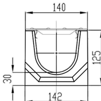
Водоотводный лоток ВЕТОМАХ BASIC, из фибробетона высотой 125мм с [целевой решеткой из оцинкованной стали](#), предназначенный для установки в пешеходных зонах, с интенсивным трафиком движения пешеходов, класс нагрузки A15 (15 kN/m<sup>2</sup>) согласно EN 1433.
