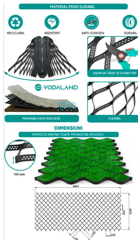
Георешетка TERRA 4943X2679мм, Н=100мм, ячейка 160x160 мм (14,3кг/модуль, S=13,2м<sup>2</sup>) - является наиболее часто покупаемой из гаммы, поскольку способна выдерживать нагрузки транспортных средств и может быть установлена на уклонах до 33 градусов.
