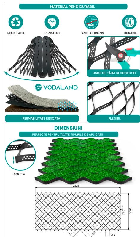
Георешетка TERRA 4943X2679мм, H=200мм, ячейка 160x160 мм (28,7кг/модуль, S=13,2м<sup>2</sup>) - используется для крупномасштабных проектов. Данная георешетка выдерживает экстремальные нагрузки и может использоваться на склонах крутизной до 45 градусов.
