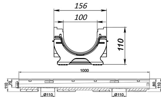
Дренажный водоотводный лоток BASE DN100 с внутренним уклоном H110мм (H70-H80мм) №4, без ливневой решетки, изготовленный из пластика.
