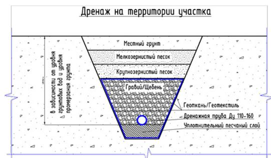
Труба дренажная с фильтром из геотекстиля, диаметр 110 мм SN4, перфорированная на 360 градусов, из непластифицированного поливинилхлорида (НПВХ). Предназначается для сбора и отвода подземных грунтовых вод при организации дренажной системы канализации и обустройстве территорий.
