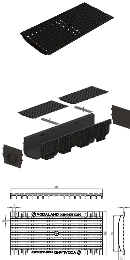
Решетка водоприемная ливневая из высокопрочного чугуна Base DN200 предназначена для установки в зонах нагрузкой до 25 тонн с неинтенсивным трафиком для устройства ливневки типа поверхностного линейного водоотвода.
