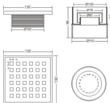
Трап для душа пластиковый с решеткой из нержавеющей стали 150x150x135, с регулируемой высотой 110-135mm и вертикальным выпуском D=100mm
