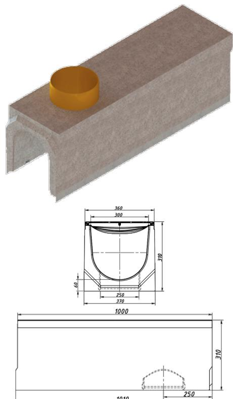
**Лоток водоотводный фибробетонный серия PRO DN300 H310 с решеткой чугунной D400 (1000x360x310) и вертикальным выпуском 250мм**
