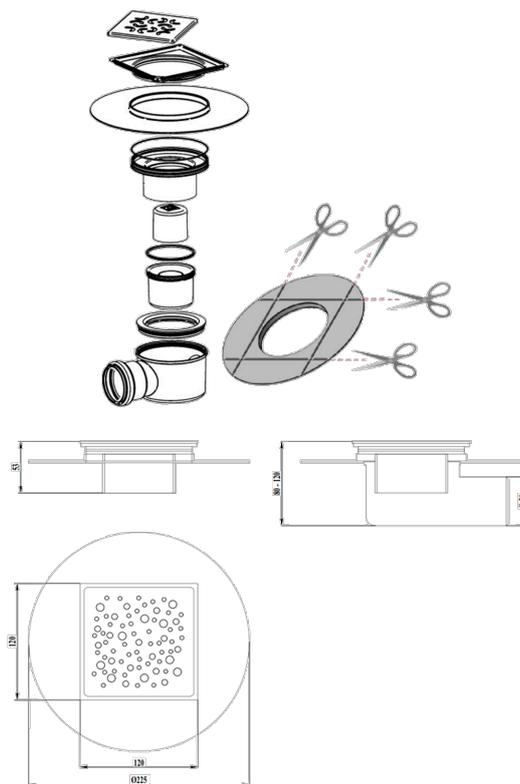
Трап для душа "Aqua" полипропиленовый с решеткой из нержавеющей стали 120x120x120, с регулируемой высотой 80-120mm и горизонтальным выходом D=50mm.
