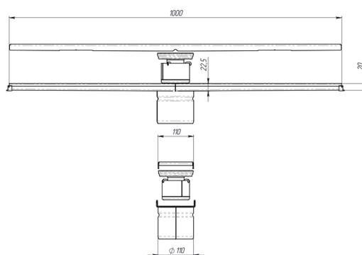
**Водоотводный лоток Valsony с перфорированной решеткой из нержавеющей стали L=1000 мм, с уклоном, гидрозатвором и сливом по центру Д=110 мм**
