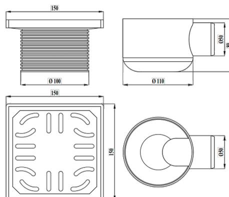
Трап для душа пластиковый с решеткой нержавеющей, регулируемый по высоте H=90-120mm, с горизонтальным выходом D=50mm.
