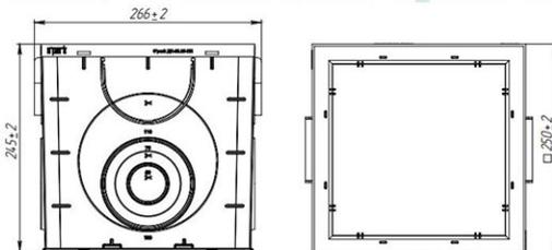
Дождеприемник Spark пластиковый квадратный, оснащенный корзиной и пластиковой решеткой. Предназначается для сбора и отвода дождевых и талых вод в пешеходных зонах. Дождеприемник Spark может устанавливаться как отдельно так и в месте с водоотводными лотками серии Spark DN70 и Spark DN100. К дождеприемнику можно подключиться отводными трубами ДН50, ДН100, ДН160 с четырех сторон через предусмотренные шаблоны.
