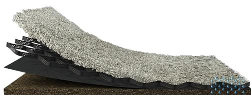
Георешетка TERRA 6000X2550 мм, H=100 мм, ячейка 220x220 мм (13,5 кг/модуль, S=15,3 м<sup>2</sup>) - является наиболее часто покупаемой из гаммы, поскольку способна выдерживать нагрузки транспортных средств и может быть установлена на уклонах до 33 градусов.
