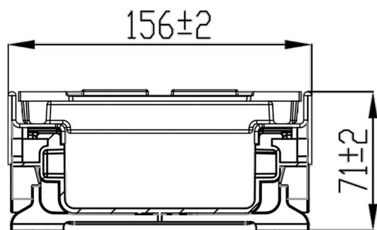
Лотки водоотводные PolyMax Drive с внутренним сечением 100 мм и высотой 71мм, укомплектованны решётками щелевыми чугунными класса D400 (выдерживающие нагрузку до 40 тонн).
