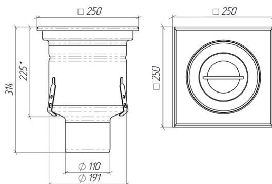
Трап 250x250 мм из нержавеющей стали с горизонтальным выпуском D110 мм, с гидрозатвором, корзиной для сбора механических примесей и решеткой щелевой.
