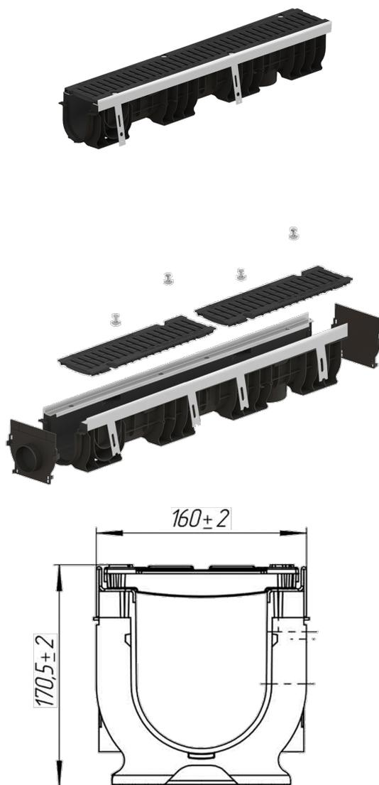
Лотки водоотводные PolyMax Drive с внутренним сечением 100 мм и высотой 171мм, укомплектованны решетками щелевыми чугунными класса D400 (выдерживающие нагрузку до 40 тонн).
