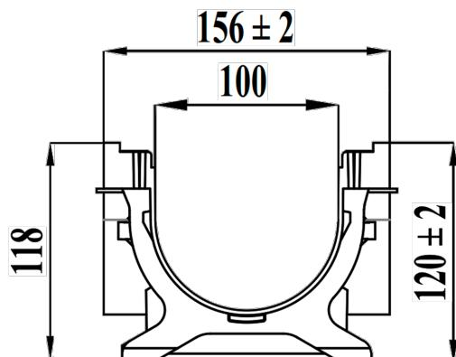
Дренажный водоотводный лоток PolyMax Basic DN100 H120, без ливневой решетки, изготовленный из пластика. Данный водоотводный лоток комплектуется любыми решетками (решетка из оцинкованной стали, решетка из высокопрочного чугуна, решетка пластиковая, решетка из нержавеющей стали, медная решетка, крышкой из оцинкованной стали) из серии Basic DN100, которые выдерживают разную нагрузку: A15 (15 kN), B125 (125 kN) или C250 (250 kN) согласно стандарту EN 1433.
