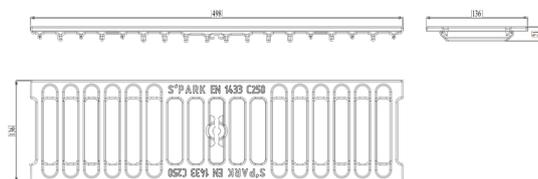
Решетка водоприемная ливневая из высокопрочного чугуна Basic DN100 предназначена для установки в зонах нагрузки до 25 тонн с неинтенсивным трафиком для устройства ливневки типа поверхностного линейного водоотвода. Класс нагрузки гриля C250 с системой винтового крепления.
