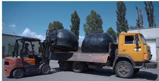
Емкость двухслойная, горизонтальная объемом 5000 литров, для хранения и перевозки пищевых и технических жидкостей, а также для хранения и перевозки Карбамидно-Аммиачной Смеси (КАС). Емкость КАС можно закрепить на кузов автомобиля для осуществления перевозки жидкостей или удобрений. В конструктиве емкости присутствуют два паза для ремней крепления емкости с кузовом автомобиля, также крышка емкости оснащена дышащим клапаном, для сброса лишнего давления которое может появиться в емкости.
