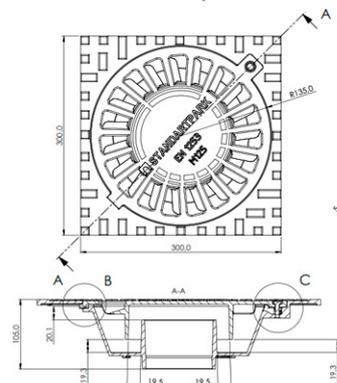
Трап чугунный 300x300 мм оснащенный гидрозатвором, предназначается для сбора и отвода талых, ливневых и загрязненных стоков (автомойки, производственные цеха) с установкой в зонах с неинтенсивным трафиком движения легковых автомобилей или спецтехники, класс нагрузки M125 (125 kN) согласно стандарту EN 1253. Трап оснащен раструбом для вертикального подключения к трубе диаметра 110 мм.
