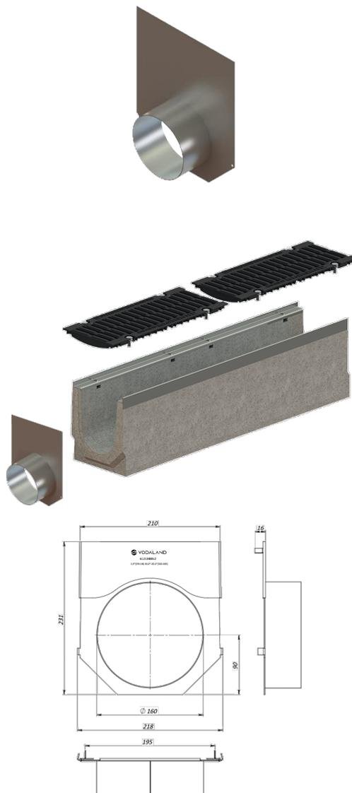
Заглушка торцевая стальная с выпуском Д160мм, для водоотводных лотков Betomax Pro DN150 H260-310, предназначена для установки в торце линии водоотводных лотков для отвода воды через дотированный патрубок.
