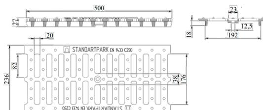
Решетка водоприемная ливневая из высокопрочного чугуна Basic DN200 предназначена для установки в зонах нагрузкой до 25 тонн с неинтенсивным трафиком для устройства ливневки типа поверхностного линейного водоотвода.
