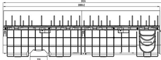
Водоотводный лоток PolyMax Base DN100, пластиковый высотой H=200мм с пластиковой щелевой решеткой, предназначенный для установки в пешеходных зонах, с интенсивным трафиком движения пешеходов, класс нагрузки A15 (15 kN/м<sup>2</sup>) согласно EN 1433, для устройства ливневки типа поверхностного линейного водоотвода.
