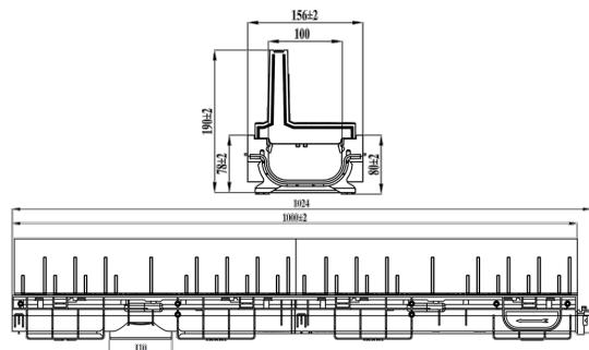
Водоотводный лоток PolyMax Base DN100, пластиковый высотой H=80мм с пластиковой щелевой решеткой, предназначенный для установки в пешеходных зонах, с интенсивным трафиком движения пешеходов, класс нагрузки A15 (15 kN/m<sup>2</sup>) согласно EN 1433, для устройства ливневки типа поверхностного линейного водоотвода.
