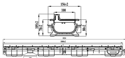
Водоотводный лоток PolyMax Base DN100, пластиковый высотой H=80мм с пластиковой щелевой решеткой, предназначенный для установки в пешеходных зонах, с интенсивным трафиком движения пешеходов, класс нагрузки A15 (15 kN/m<sup>2</sup>) согласно EN 1433, для устройства ливневки типа поверхностного линейного водоотвода.
