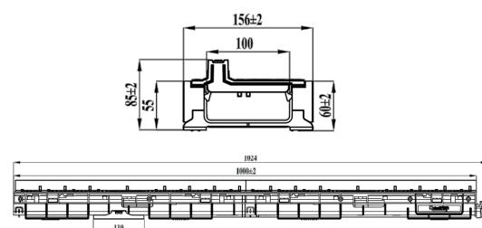
Водоотводный лоток PolyMax Base DN100, пластиковый высотой H=60мм с пластиковой щелевой решеткой, предназначенный для установки в пешеходных зонах, с интенсивным трафиком движения пешеходов, класс нагрузки A15 (15 kN/m<sup>2</sup>) согласно EN 1433, для устройства ливневки типа поверхностного линейного водоотвода.
