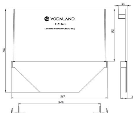
Заглушка торцевая стальная для водоотводных лотков Vetomax Pro DN100 H170-230, предназначена для установки в торцах линии водоотводных лотков создавая герметичность линейного водоотведения.
