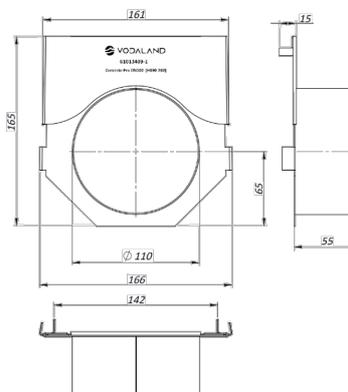
Заглушка торцевая стальная с выпуском Д110мм, для водоотводных лотков Betomax Pro DN100 H190-230, предназначена для установки в торце линии водоотводных лотков для отвода воды через дотированный патрубок.
